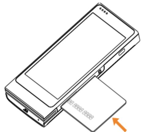
**Kontaktlosleser:** Halten Sie die Karte während des Bezahlvorgangs ca. 1 Sekunde lang nahe an die Landing Zone der Druckerabdeckung, bis Sie einen „Piepton“ hören. Das bedeutet, die Transaktion wurde erfolgreich abgeschlossen. Zu diesem Zeitpunkt kann die Karte entnommen werden.
